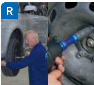
R Para evitar daños en el eje de la rueda y/o para evitar desviaciones en la planeidad de los discos de freno deben colocarse los tornillos y las tuercas de la rueda siguiendo los datos del fabricante (en cuanto a su orden y al par de apriete).
