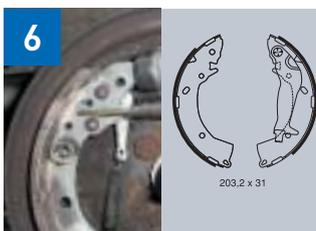
6 En caso necesario, comprobar si los dispositivos de ajuste presentan algún daño o desgaste. Para montar correctamente las zapatas de freno (zapata primaria y secundaria). Consulte el catálogo de HELLA PAGID BRAKE SYSTEMS donde se representa siempre el freno trasero izquierdo.
