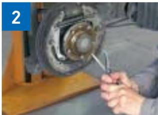
2 Para montar y desmontar los muelles de recuperación es imprescindible contar con herramientas especiales
