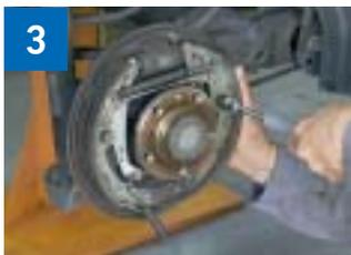
3 Para montar y desmontar los muelles de sujeción deben utilizarse herramientas adecuadas con el fin de evitar que los recambios se dañen.
