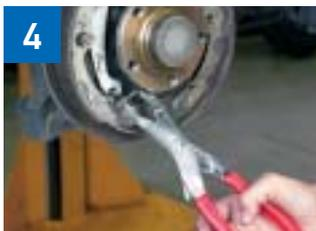
4 Para montar y desmontar el cable del freno de mano deben utilizarse herramientas adecuadas con el fin de evitar que los recambios se dañen.
