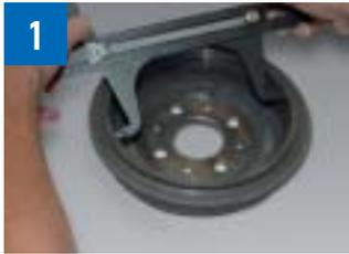
1 Comprobar si el tambor está desgastado o dañado. Medir el diámetro. La nueva medida más 0,5 mm hasta el diámetro máximo solo puede utilizarse con pastillas que superen esta medida.
