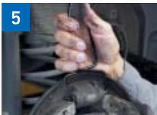
5 Al desmontar las zapatas de freno hay que asegurar los pistones con una herramienta adecuada.
