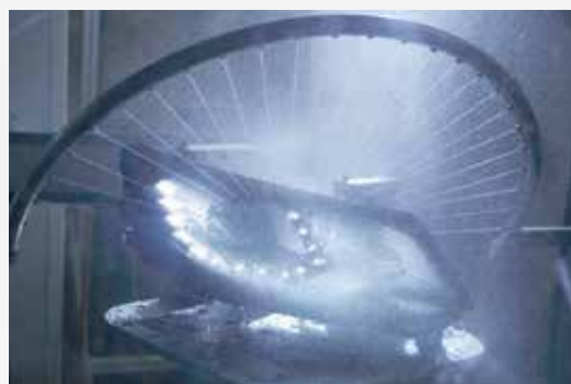
Prueba de lavado a presión
