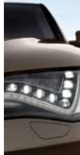
Primer faro entero de LED con foco de baja / alta, diseño moderno y función AFS - Audi A8 (1 en el mercado)
