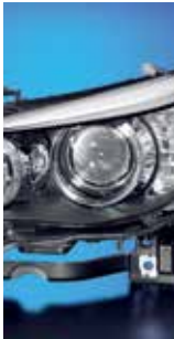
LED Los faros ya cuentan con luz de señalización
